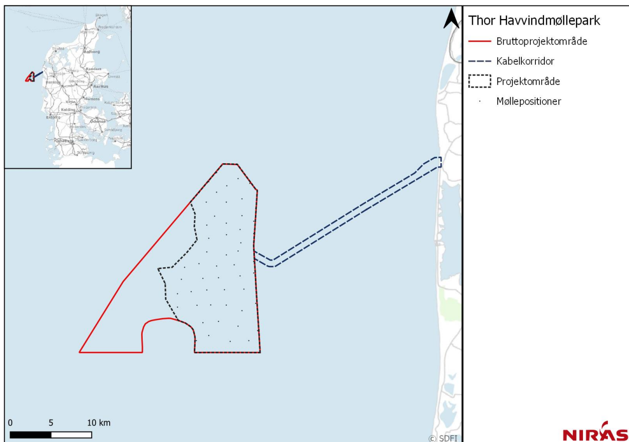
Figur 1.1: Afgrænsning af bruttoprojektområde, projektområde og kabelkorridor for Thor Havvindmøllepark. Positionerne af de 72 havvindmøller er ligeledes vist.
