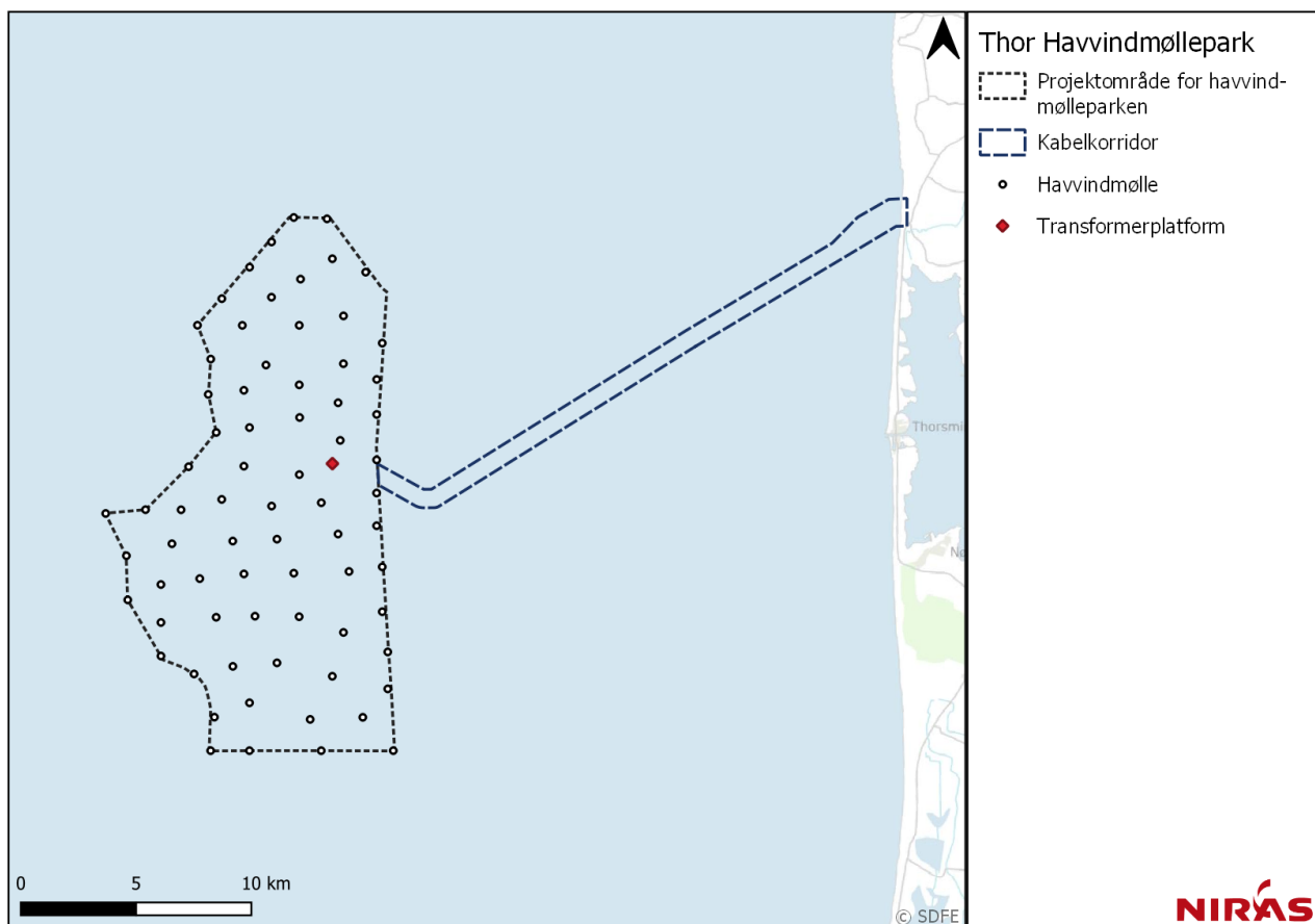
Figur 2.2: Projektområdet for Thor Havvindmøllepark samt angivelse af positioner for havvindmøller og transformerplatform.
